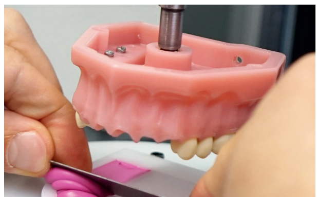
Abb. 3 Jede Messung wurde fünfmal durchgeführt und jede Serie nach Mittelwert und Standard-Deviation ausgewertet. Materialien aus Mischspritzen wurden jeweils in die Aussparung der POM-Form eingebracht und mit deren Oberkante glattgestrichen.
