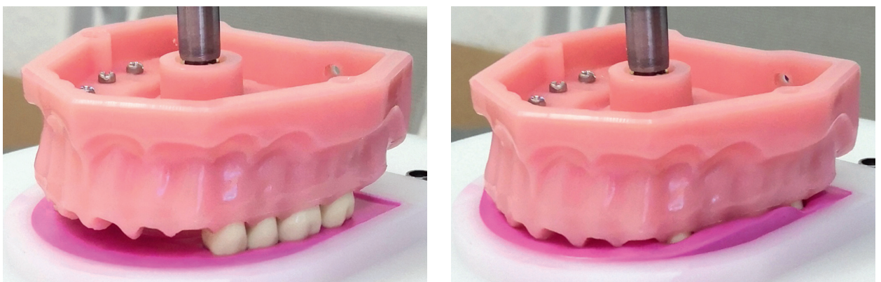
Abb. 6 Die Hälfte des am gesamten Modell gemessenen Unterschieds in der Verformungskraft zwischen 2x4 Zähnen und 2x2 Zähnen sollte etwa der Kippkraft entsprechen, die beim Eindringen in das Registriermaterial auf den Unterkiefer einwirkt.
