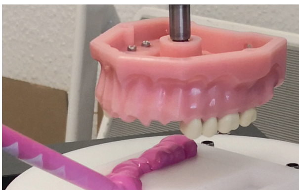
Abb. 3 Jede Messung wurde fünfmal durchgeführt und jede Serie nach Mittelwert und Standard-Deviation ausgewertet. Materialien aus Mischspritzen wurden jeweils in die Aussparung der POM-Form eingebracht und mit deren Oberkante glattgestrichen.
