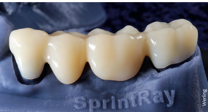
Abb. 2c Das Modell wurde in 100 µm als Kontrollmodell auf dem SprintRay Pro95, Meistermodelle werden mit 50 µm gedruckt.
