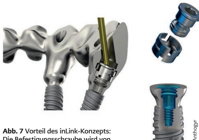
Abb. 7 Vorteil des inLink-Konzepts: Die Befestigungsschraube wird von basal mit einem Haltering eingebracht.
