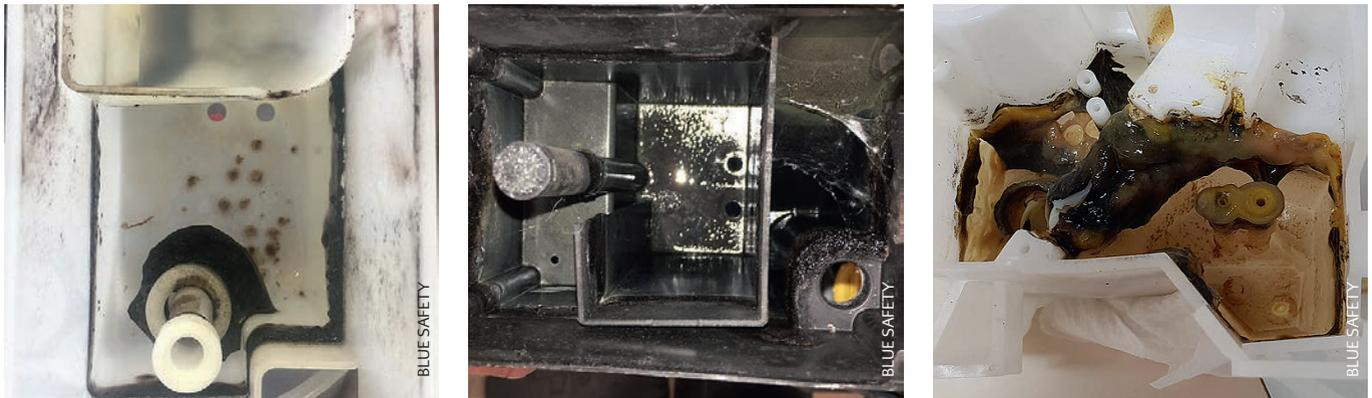
Die freie Fallstrecke bzw. Mischkammer bietet Biofilmen, Schimmelsporen und Pilzen ideale Wachstumsvoraussetzungen.
